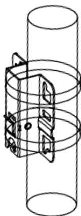
Figura 3-3 Montaje de la placa en un soporte vertical
